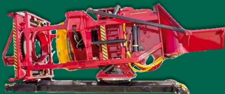
forma rápida e fácil ao veículo de base, através de um sistema de cilindros hidráulicos de apoio. A ENFO-2000 com o processo de compressão e atamento consegue reduzir até 80% o volume da biomassa, fazendo fardos compactos, manejáveis e resistentes que podem ser facilmente transportados e armazenados.
